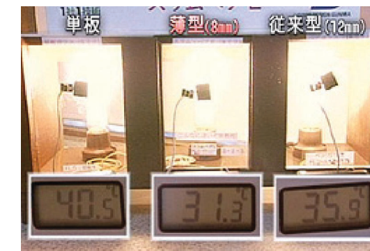
ガラスの断熱性の比較実験。単板と従来の複層ガラス、及び薄型のスリムペアの3つで比較。5分後の断熱性は従来のものと遜色ない。
